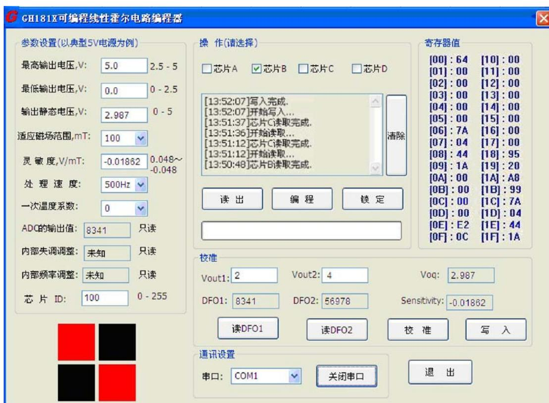
下面以一个角度传感应用为例，来说明校准操作。如果想让芯片当角度为0时输出2V，则在Vout1栏中写入2，在角度为90度时芯片输出为4V，则在Vout2栏中写入4，将芯片处于角度0的位置，按下“读DFO1”，软件将读出此时芯片内部数字滤波器的输出值（Digital filter output，DFO）也即参数设置栏中的ADC的输出值，并显示在读DFO1的空格中（8341），再将芯片处于角度90度的位置，按下“读DFO2”，软件将读出此时芯片内部数字滤波器的输出值，并显示在DF02的空格中（56978）。下一步，按下“校准”，则芯片要调整的静态输出电压会显示在Voq栏中，要调整的灵敏度（感应强度）会显示在sensitivity栏中。再按“写入”键，则这两个参数就会写入到芯片中。
