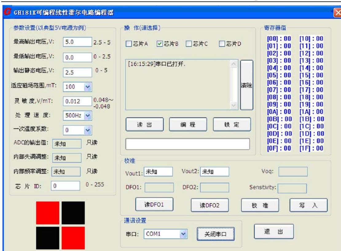
可以看到此时读出、编程、锁定、读 DFO1、读 DFO2、校准、写入，这些编程操作指令按钮全部呈黑色高亮可操作状态。编程状态提示栏中，提示串口已打开，此时进入了可编程状态。
