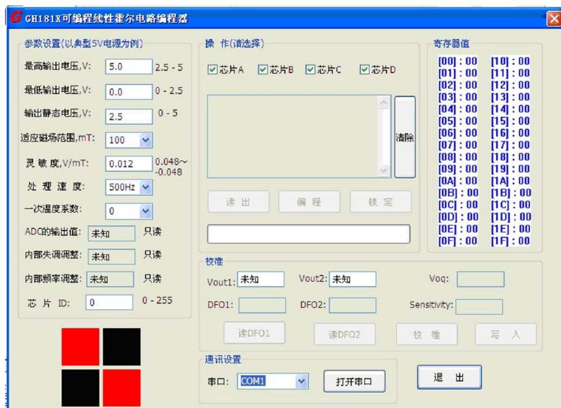
此时读出、编程、锁定、读 DFO1、读 DFO2、校准、写入这些编程操作指令按钮全部呈灰色不可操作状态，根据实际情况中的串口线接入计算机的哪个串口，在串口菜单中选择相应的 COM 值（一般是 COM1），并点击“打开串口”。串口线接到了哪个串口可以鼠标右键点击“我的电脑”图标-属性-硬件-设备管理器-端口中查看。
